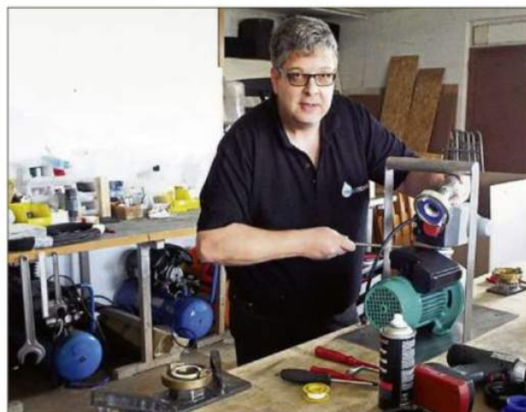
Markus Walter montiert eine Wasserpumpe in ein von ihm konstruiertes Traggestell: Maßgeschneiderte Sonderlösungen fertigt er für seine Kunden. Foto: Schnurr
