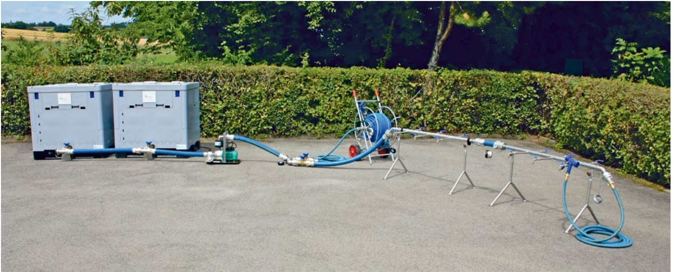
Beispielanlage für eine Trinkwasser-Notversorgung mit 2000 Litern Speichervolumen, Pumpe und Zapfstellen
